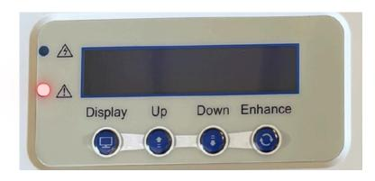
Lorsque la LED rouge reste fixe, cela signifie que le routeur ne fonctionne pas et est en alarme. Vérifiez les branchements et la configuration. Si cela persiste, contactez-nous via :
