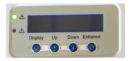
Lorsque la LED verte clignote en journée, cela signifie que le routeur fonctionne et utilise l'énergie produite en trop des panneaux solaires pour chauffer le chauffe-eau.
